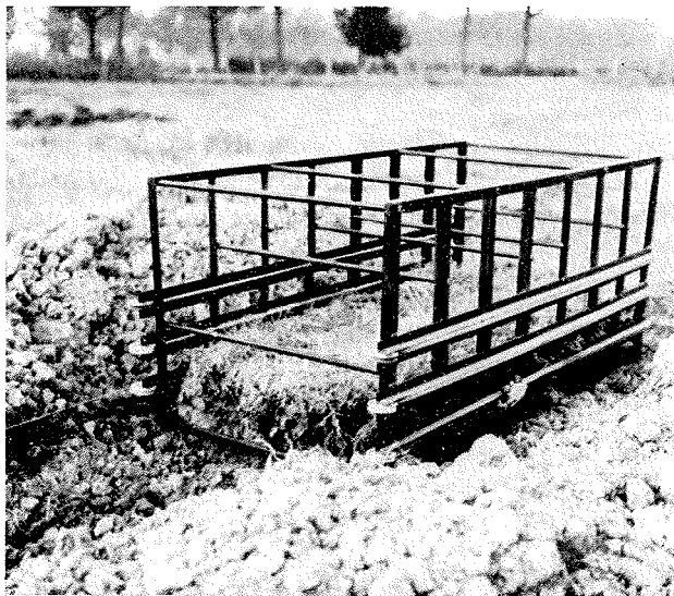
Fig. 5. — Il filo tagliante in lavoro: sono visibili i pattini e i cavetti di trazione.
